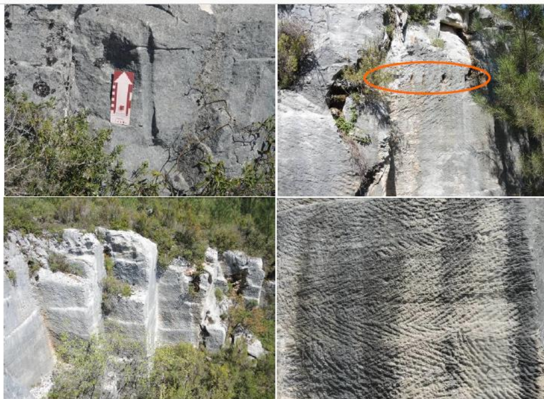
Figura n.º 62: Vestígios de exploração de pedra – “Explorações da Barrosinha” (n.º 4): sulcos provenientes das cunhas; orifícios deixados pelo escopro; vista de uma frente de exploração; pormenor das marcas deixadas aquando do desbaste, com os martelos denteados ou gradins.
